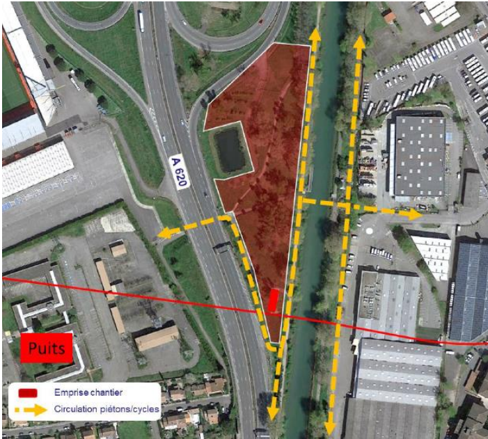
Fig.4 L'emprise chantier et les déviations des cheminements
